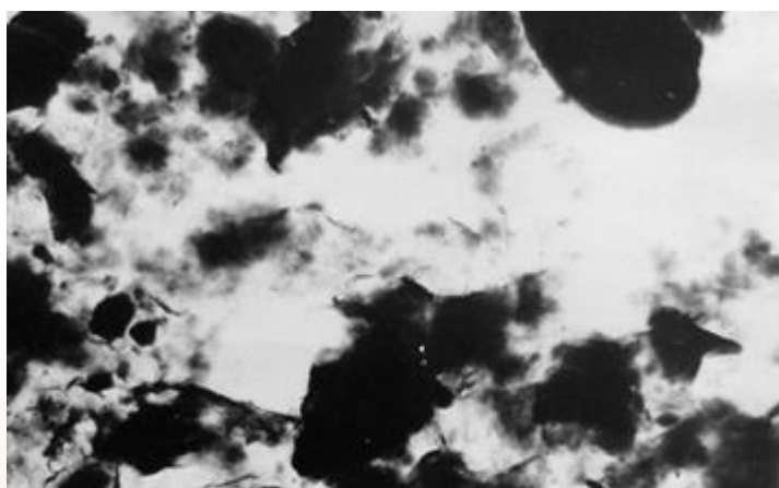
Рис. 3.4. Электронная микрофотография бентонита (x15000)
