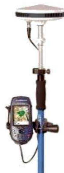
1.3-расм. “Mobile Mapper” режимида съёмка қилиш
