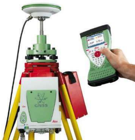
1.1-расм. Leica GS-10 маркадаги тўлқин қабул қилгич қурилмаси
