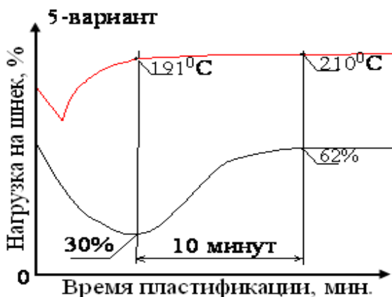
Рис. 26. Пластограмма госсиполовой смолы в ПВХ-композиции. Концентрация 1,0 масс.ч.
