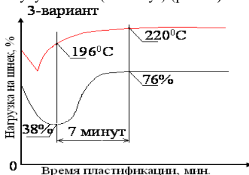
Рис. 24. Пластограмма кальцевая соли продукта-Т и шорсита в ПВХ-композиции. Концентрация 4,0 масс.ч.
